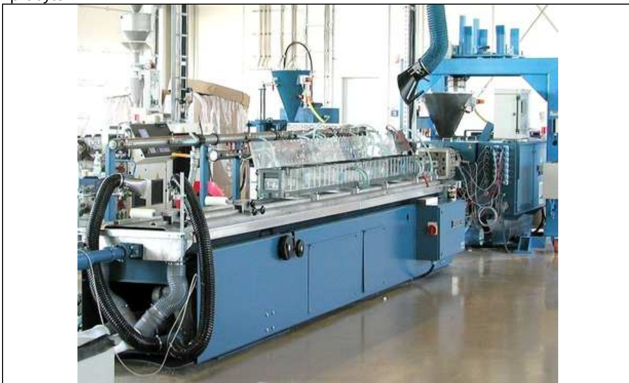
Příklad vytlačovací linky: vytlačovací stroj – extruder vpravo, kalibrace vlevo.
