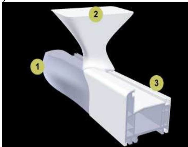
Vytváření profilů s recyklátem v jádru; 1.základní profil, 2. primární surovina, 3.výsledný koextrudovaný profil
