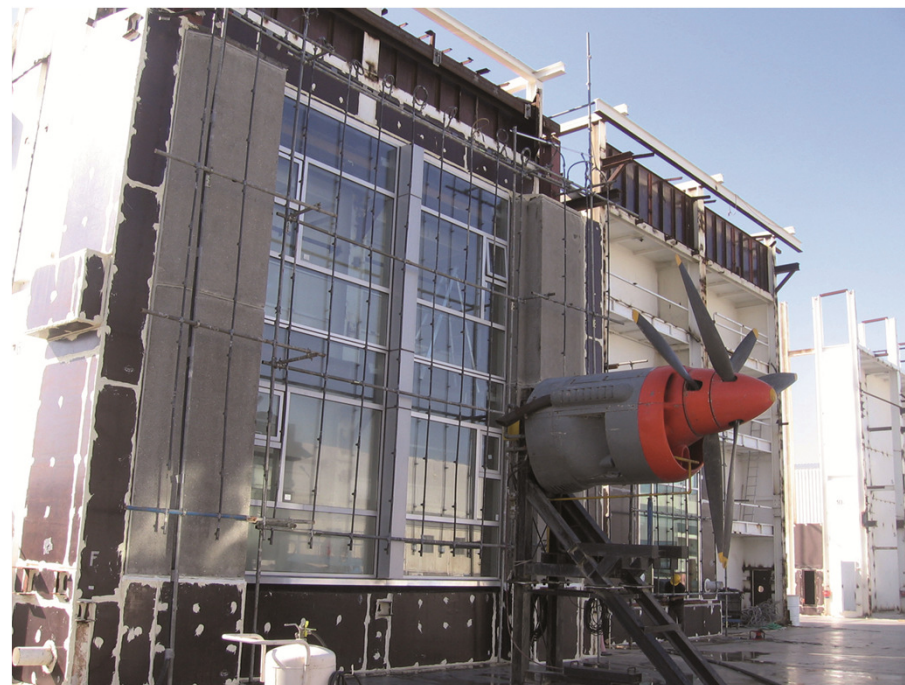
Dynamická odolnost proti vodě je testována pomocí vrtule letadla.
