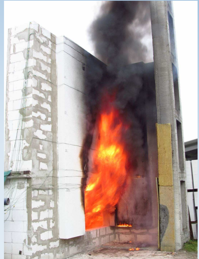
ISO 13785-2 zkouška ve velkém měřítku (výška vzorku nad hranou okna \geq 4 m, \sim 3 MW)
