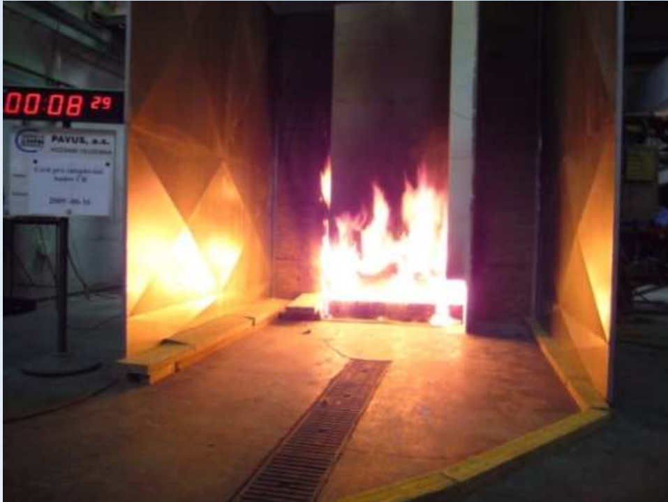
ISO 13785-1 zkouška Zkouška středního rozměru (výška vzorku nad hranou 2,4 m, 100 kW)
